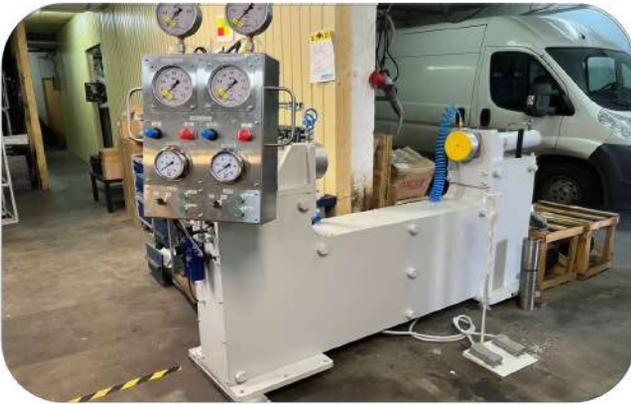
испытание: задвижки, краны, клапаны и др.
